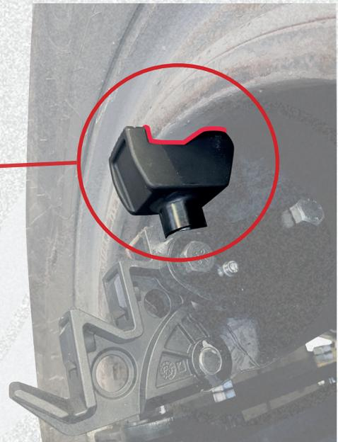
Il profilo della griffa di bloccaggio, unico nel suo genere, è stato progettato in modo tale che copi esattamente il profilo del bordo esterno del cerchio. Utilizzando questo accessorio, la ruota sarà bloccata sulla morsa della macchina in modo sicuro e veloce, assicurando una solida tenuta in entrambe le direzioni di stallonatura.
